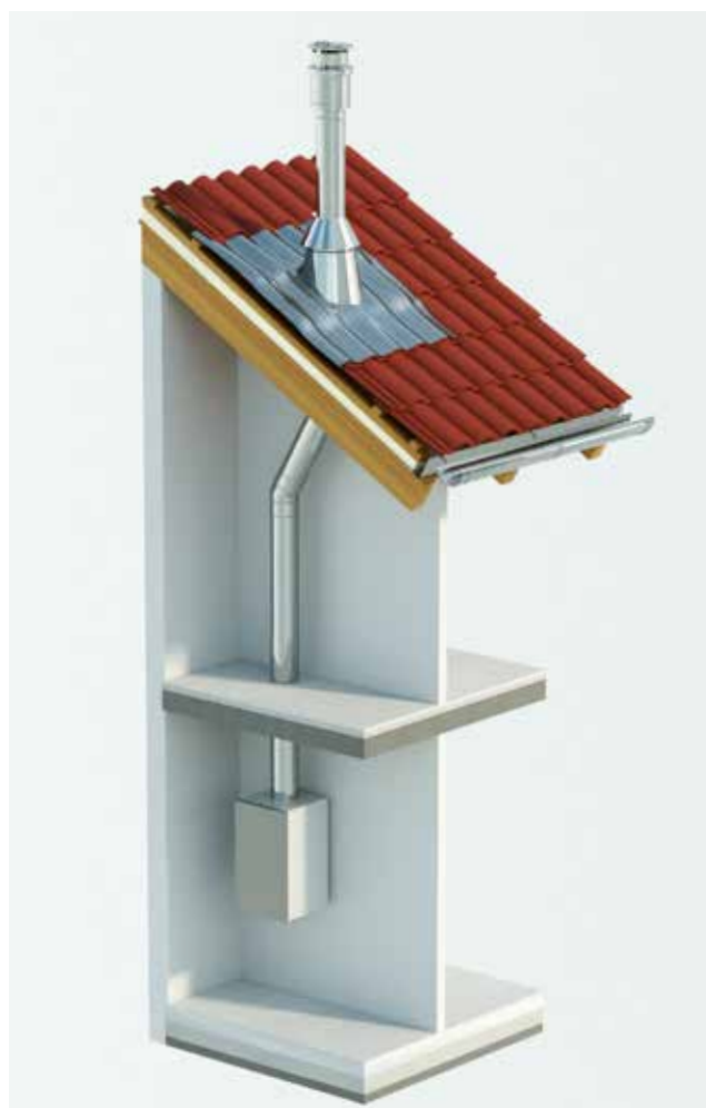
Installazione interna all'edificio con attraversamento a tetto
